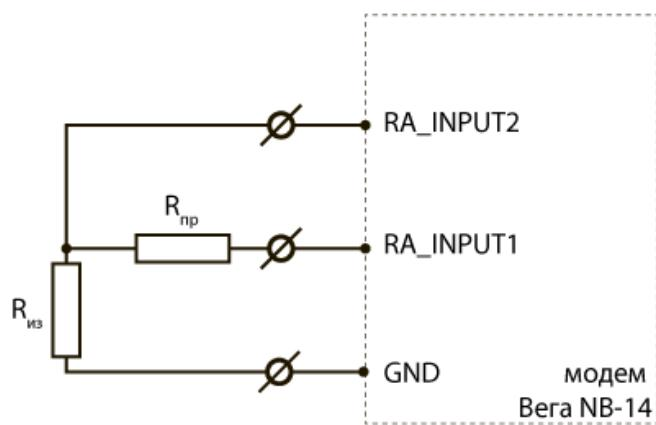
Устройство измеряет сопротивление по схеме подключения, изображенной выше, после чего определяет наличие дефектов изоляции трубопровода или сигнального провода. Таблица контрольных значений:
